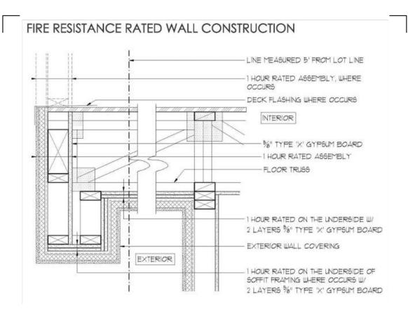
TABLE R302.1(1) - THE MINIMUM FIRE RESISTANCE RATING OF A PROJECTION SHALL BE 1-HOUR ON THE UNDERSIDE WHEN THE EXTERIOR WALL IS CLOSER THAN 5'-0"TO THE PROPERTY LINE.
